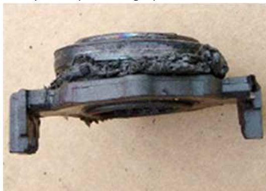
Surchauffe butée suite à un manque de pré charge
